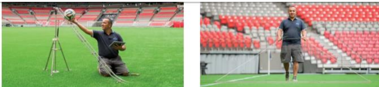
Ilustración 3. Pruebas de rodada en caída y en horizontal realizados por un laboratorio acreditado por la FIFA
